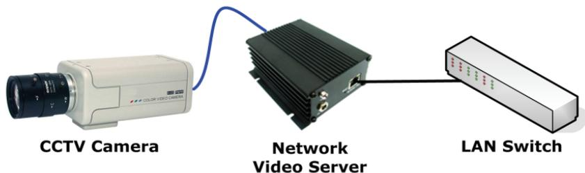
*L'esempio mostra una telecamera CCTV connessa a un server video di rete, connesso a sua volta alla rete.*
